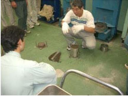
11. 規定回数突き固めた試料を基に粒度による影響を説明。
