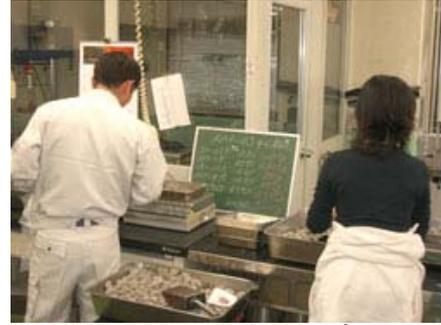
12. 計算結果から中間粒度のサンプルを作るための計量。
