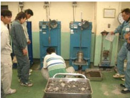
7.突き固め試験機による締まる具合の実証。
