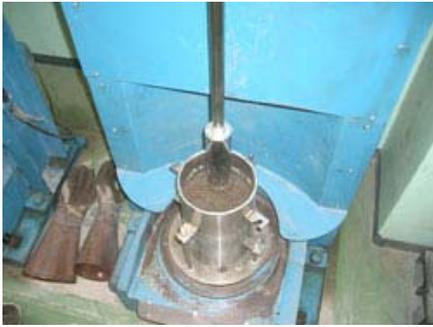
9. 突き固め。荒い粒度だと締りが悪い。
