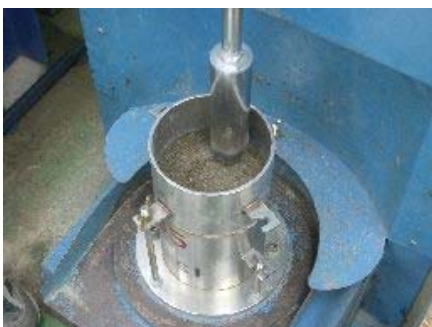
13.突き固め試験機の落錘状況。
