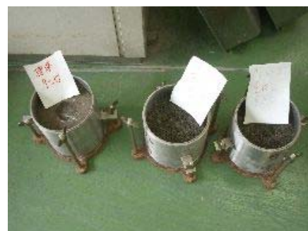
16.再生アスコンの混合率変化での締まり具合の目視。
