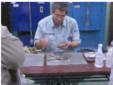
17.清野課長による液性限界試験機の試料作り。
